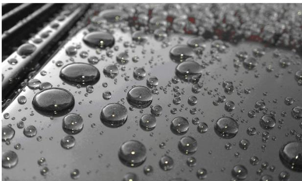
Рис. 3. Капельки воды на обработанной воском поверхности автомобиля
